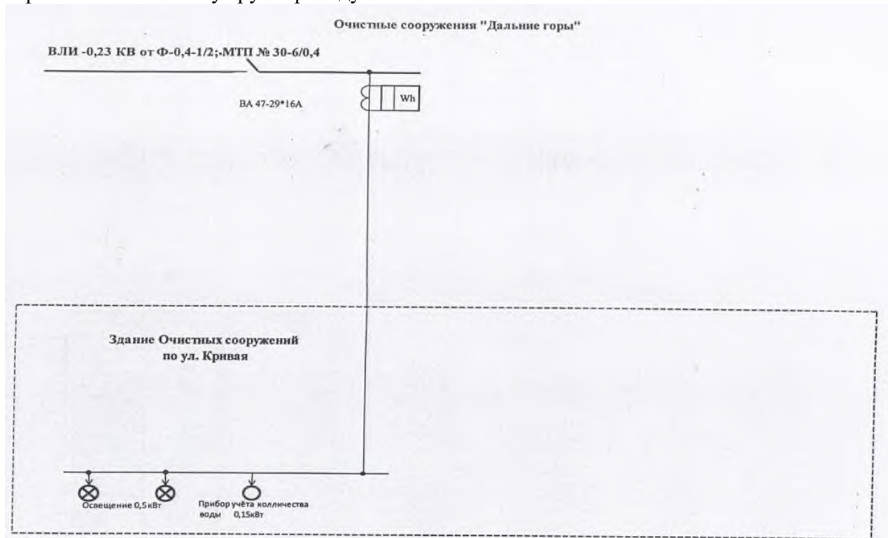
Рисунок 2.23 – Схема электроснабжения КОС «Дальние горы», в нормальном режиме
